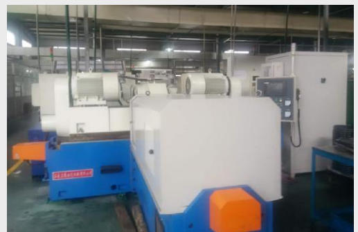
11月,八环精密科新增了先进的数控平面磨床,提高了加工精度,满足特种产品的质量要求。(廖小华)
